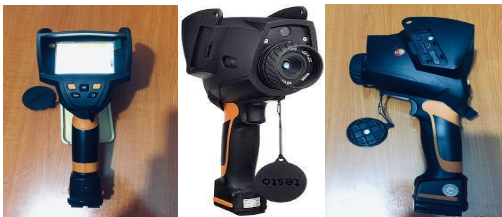
شكل (2) الكاميرا الحرارية نوع Testo 875 المستخدمة في قياس درجة حرارة النباتات تحت ظروف اجهاد الجفاف.
