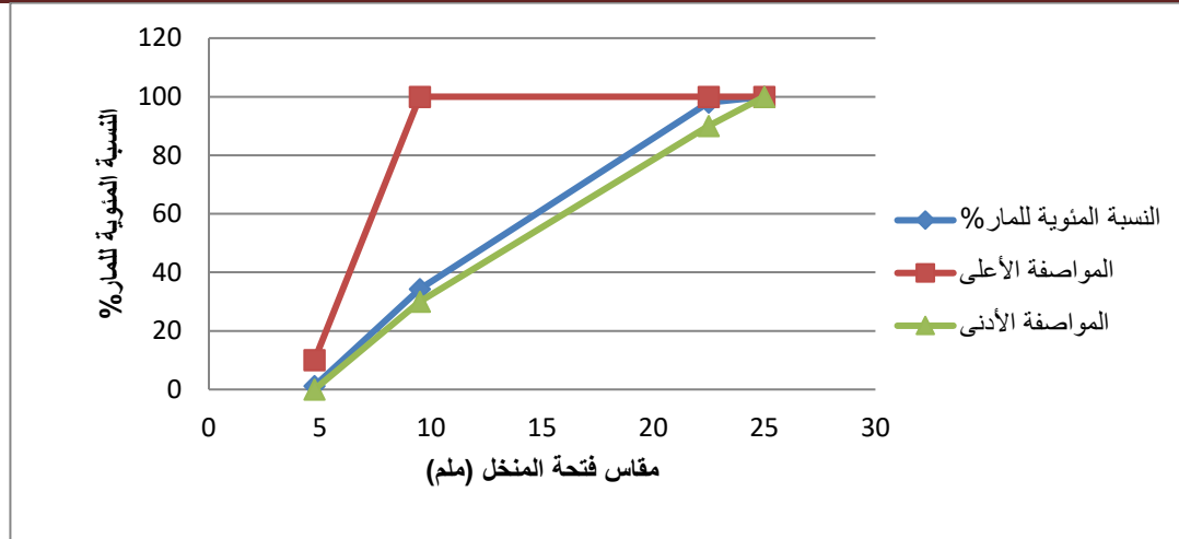
الشكل (4) التدرج الحبيبي للركام الخفيف المصنع.
