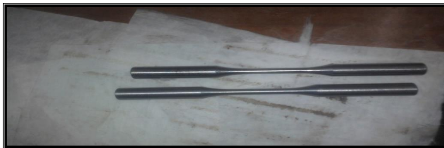
Fig. 1b : Tensile test specimen
