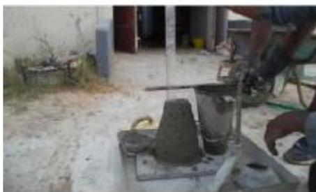
الشكل رقم (7) اختبار الهبوط خلطة المرجعية W/C=0.5
