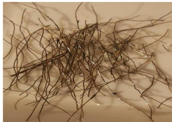
الشكل (6) يوضح شكل الالياف الفولاذية
