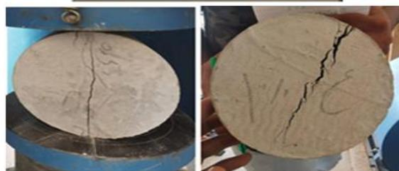
الشكل (12) اختبار مقاومة الشد للاسطوانات
