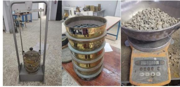
الشكل(2) يوضح اختبار التحليل المنخلي للركام الخشن
