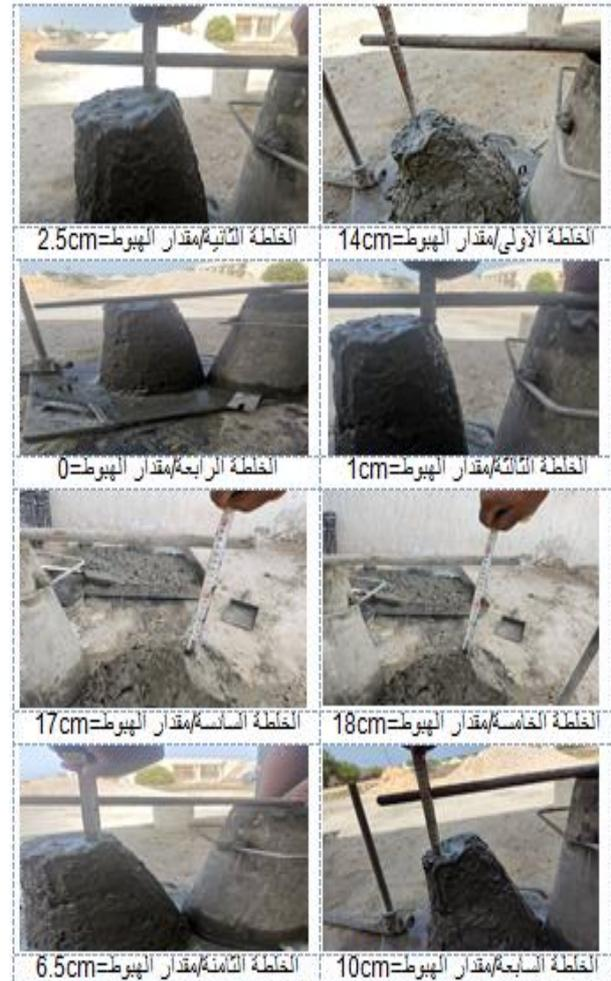
الشكل (8) طريقة قياس الهبوط للخلطات.
