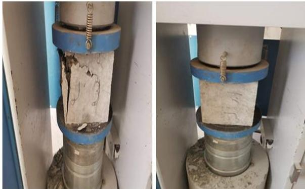
الشكل (10) يوضح طريقة اختبار مقاومة الضغط
