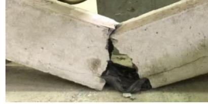
شكل رقم (16) انهيار الخرسانة وانفصال الألياف الكربونية
