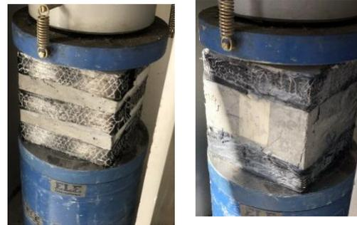
شكل رقم (14) عينات المكعبات بعد تعرضها لاختبار مقاومة الضغط
