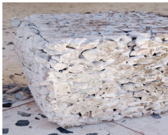
شكل رقم (9): إحدى العينات المعتمدة بعد الكسر
