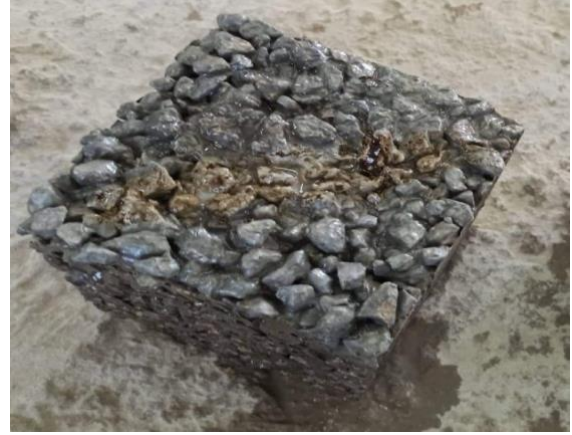
شكل رقم (5): إحدي عينات الخلطة الثالثة بعد إخراجها من حوض المعالجة
