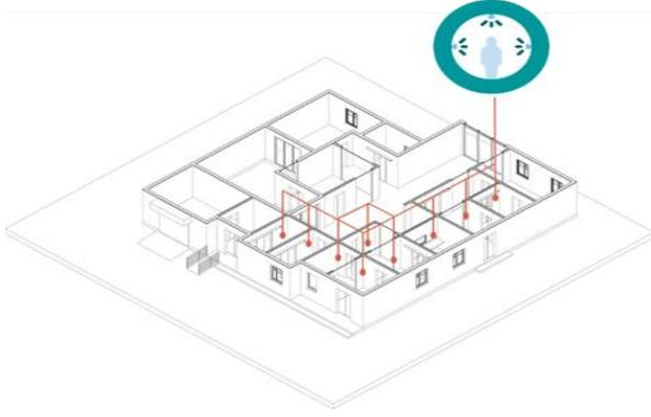
شكل (11):غرف مزودة بتعقيم ذكي (حساس مؤتمت) جهاز يعمل اتوماتيكي بدون لمس عن طريق استشعار حركة الاشخاص عند الدخول للغرف
