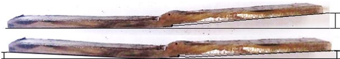
الشكل (12). يوضح التشوه الزاوي في وصلة اللحام التناكبية .
